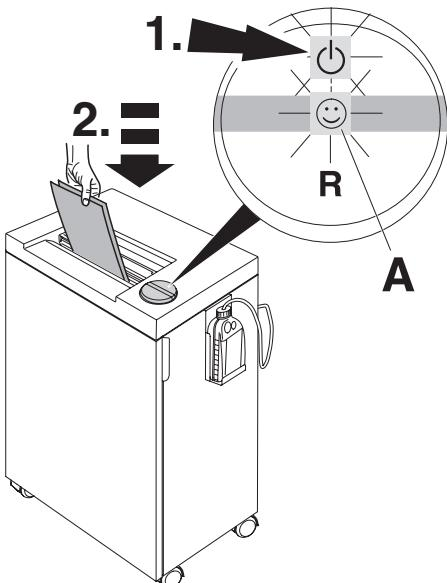
**NL** Schakelaar indrukken (1.) : groen licht gaat aan, machine is bedrijfsklaar. Start automatisch zodra papier wordt ingevoerd (2.). Automatische standby schakelt naar 30 minuten uit. De machine kan op elk gewenst moment worden uitgeschakeld door gedurende 2 seconden op de knop te drukken. Groene LED controlelampje is uit. De machine verbruikt dan geen stroom meer.
