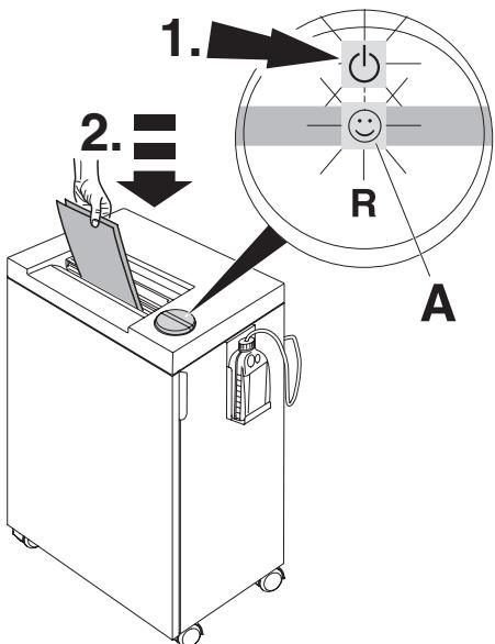
**DE** Schalter drücken (1.) : grünes Licht leuchtet, Maschine betriebsbereit. Autom. Anlauf bei Papierzufuhr (2.). Autom. Standby - Abschaltung nach 30 Minuten. Maschine kann jederzeit durch 2 sec. langes Drücken des Schalters ausgeschaltet werden. Grüne Kontrollleuchte erlischt. Danach verbraucht die Maschine keinen Strom mehr.
