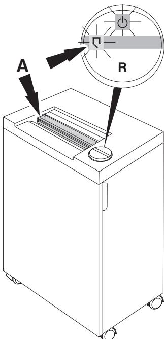
**IT** Blocco automatico se la linguetta di sicurezza è sollevata. (I simboli e lampeggiano alternatamente). Chiudere la linguetta di sicurezza e premere l'interruttore principale , la carta viene distrutta. Per eliminare eventuali frammenti dovuti al blocco, la macchina si avvia, con movimento in reverse, per un breve periodo con linguetta di sicurezza sollevata.
