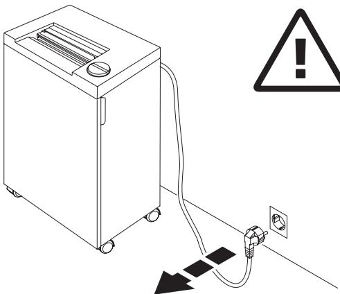
**DE** Bei der Reinigung Netzstecker ziehen!
