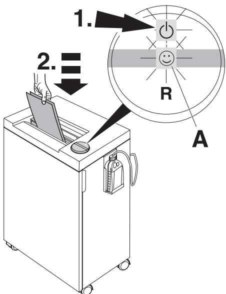
**CZ** Zmáčkněte tlačítko (1.) svítí zelené světlo, stroj je připraven k provozu. Automatické spuštění při vložení papíru (2.). Automatické standby-vypnutí po 30 minutách.
