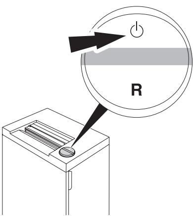
**DE** Autom. Standby - Abschaltung nach 30 Minuten. Maschine kann jederzeit durch 2 sec. langes Drücken des Schalters ausgeschaltet werden. Grüne Kontrollleuchte erlischt. Danach verbraucht die Maschine keinen Strom mehr. Innerhalb dieser 30 Minuten verbraucht der Aktenvernichter folgende Wh Energie.
